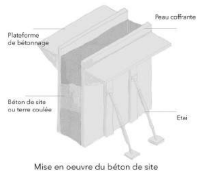
Mise en oeuvre du béton de site
