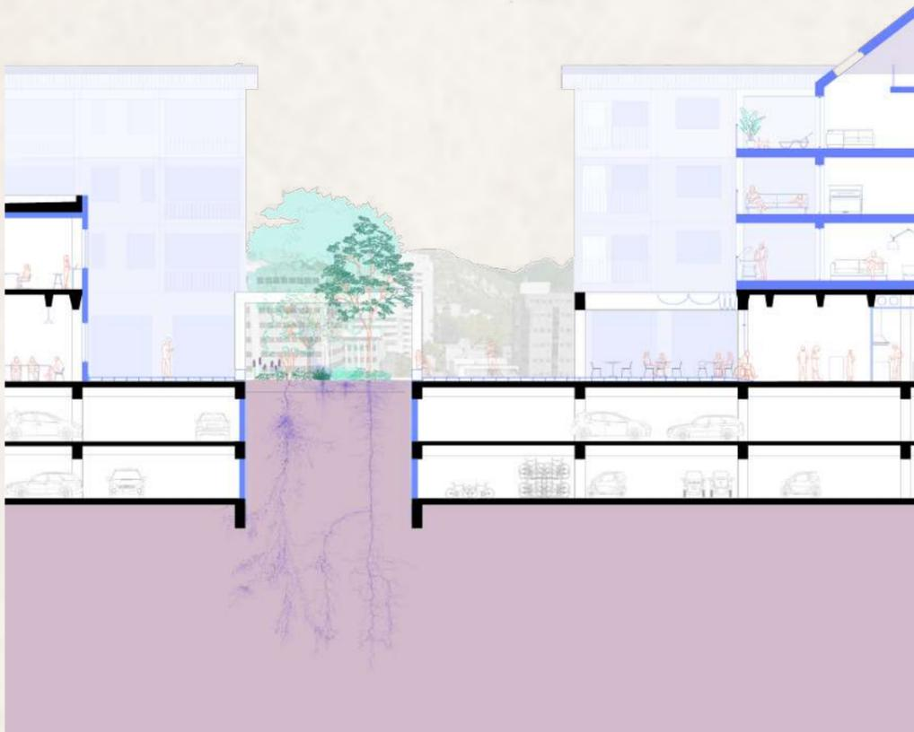
Le projet inclut l'ajout de logements en surélévation sur le bâtiment existant, construit en 1974 et largement surdimensionné, permettant d'ajouter 2 à 3 étages sans grands travaux de renforcement. La surélévation en bois, remplie de caissons préfabriqués en bois et paille, utilise des matériaux locaux, tels que l'épicéa de la scierie d'Autrans et la paille du Grésivaudan.
