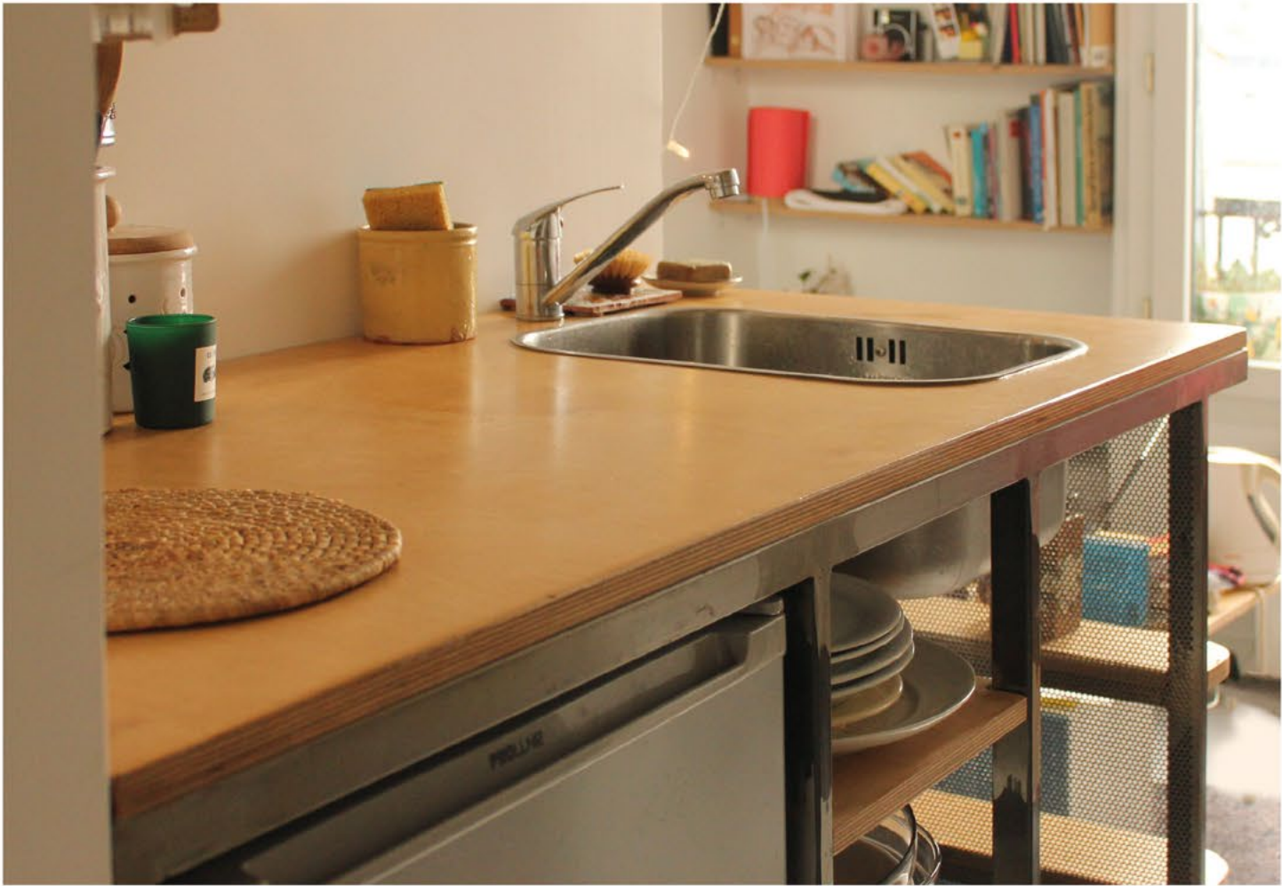
Conception et réalisation d'un meuble de cuisine pour aménager une sudette étudiante. Meuble réalisé en serrurerie métallique et en planches de bois contrecollés (anciens panneaux d'expositions).
